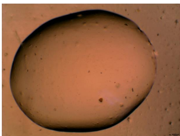
Рис. 3. Капля воды на поверхности антиобледенительного покрытия на основе акриловой смолы А-01
