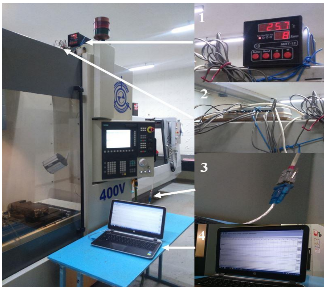
Рис. 1. Внешний вид подключённой к станку автоматизированной системы:
