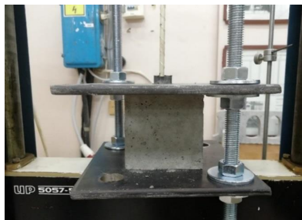
Рис. 1. Схема образца для испытания на выдергивание
